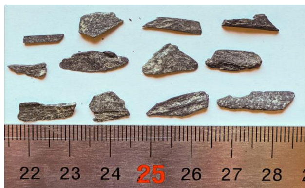
Рис. 4. Образцы обвального аргиллита, полученного в процессе бурения с глубины 2100-2130 м по скважине 1
