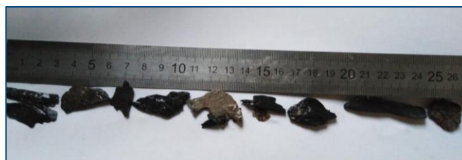
Рис. 11. Образцы обвального аргиллита и доломита, полученных во время проработки при забое 3290 м
