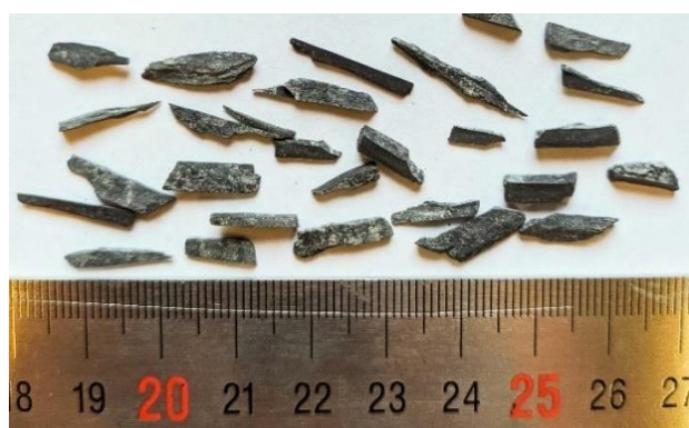
Рис. 5. Образцы обвального аргиллита, полученного в процессе бурения с глубины 2220-2240 м по скважине 2
