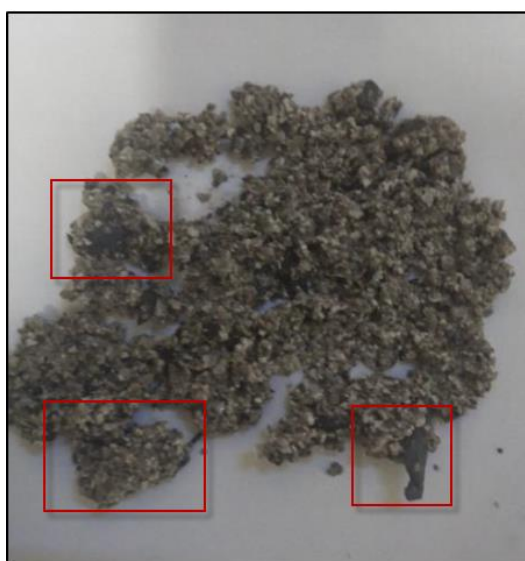
Рис. 8. Образцы выбуренного шлама с частицами обвального аргиллита, полученного в процессе бурения с глубины 3175-3500 м
