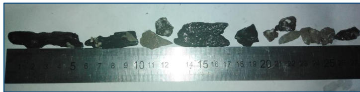
Рис. 12. Образцы обвального аргиллита и доломита, полученных во время проработки при забое 3488 м
